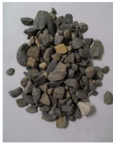
圖 3-13 天然骨材 (a)細骨材(砂) (b)粗骨材
