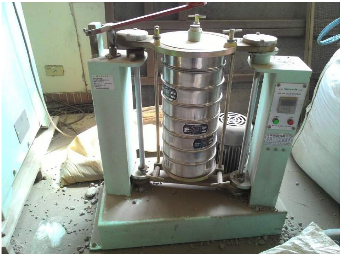
圖 3-21 細骨材粒徑分析-搖篩機
