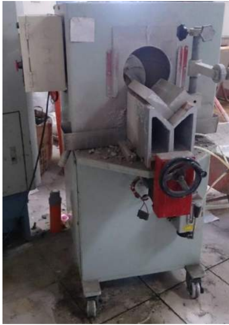
圖 3-33 混凝土試體表面打磨機
