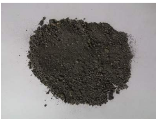
圖 3-16 改質轉爐石粗骨材
