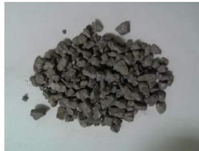
圖 3-14 標準細骨材(符合 ASTM C778 規定)
