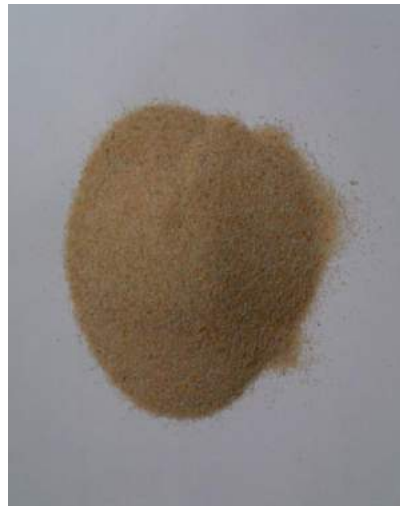
圖 3-14 標準細骨材(符合 ASTM C778 規定)
